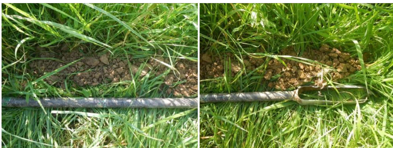
Ci-dessus, un profil pédologique humide (Sondage 2-1) : les marques d'hydromorphie apparaissent directement après l'horizon de terre végétale et se poursuivent en profondeur.
