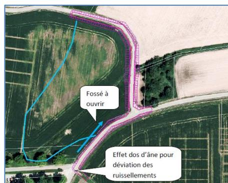
La vidange de ce bassin serait réalisée dans le ruisseau avec un débit de fuite acceptable par le DN600. Le plan du bassin figure en page précédente, ainsi que sa zone de remplissage maximale.
